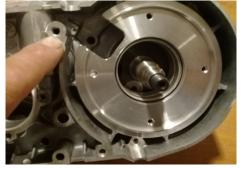
**2-** INSERT **MVT** BASE PLATE ON THE ENGINE AND ADJUST THE WIRE EXIT CONDUCT ON THE RIGHT POSITION.
